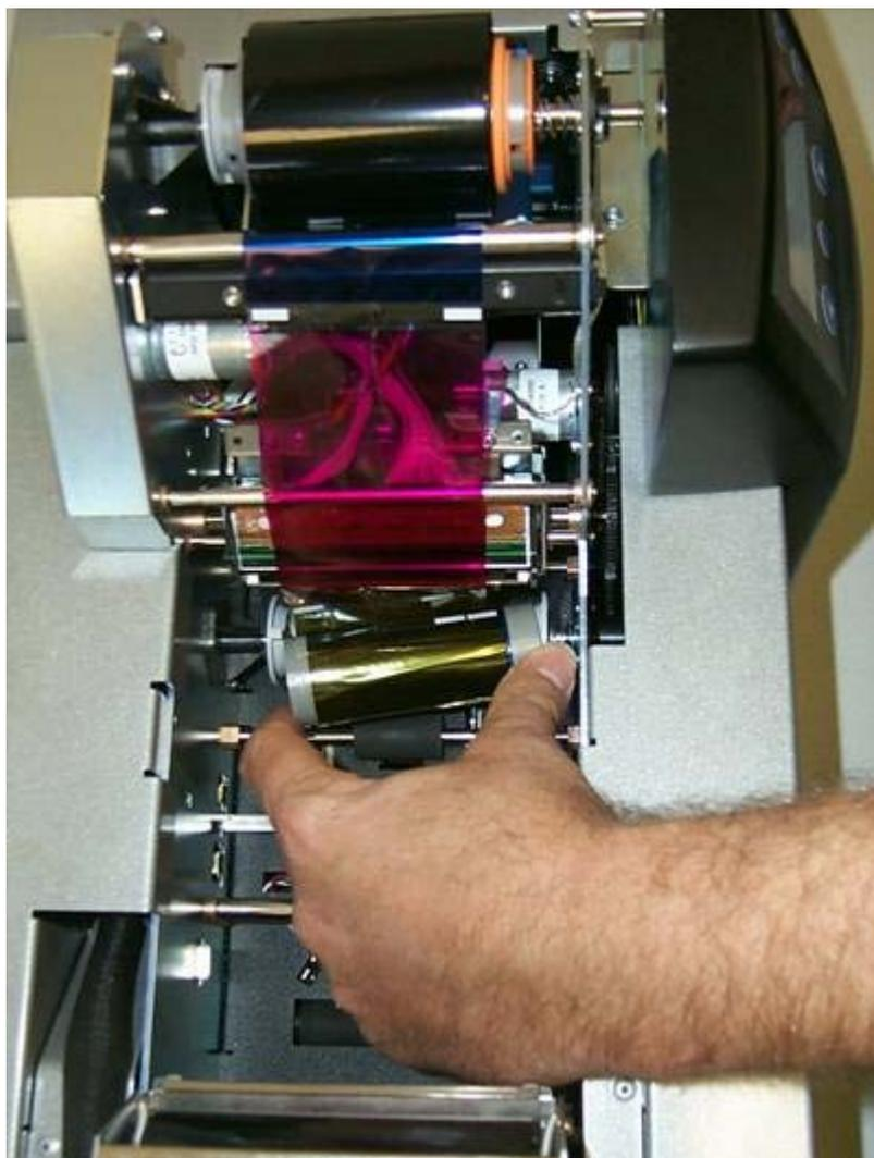
Рисунок D (внизу) – Внизу показан результат успешной установки печатной ленты.
