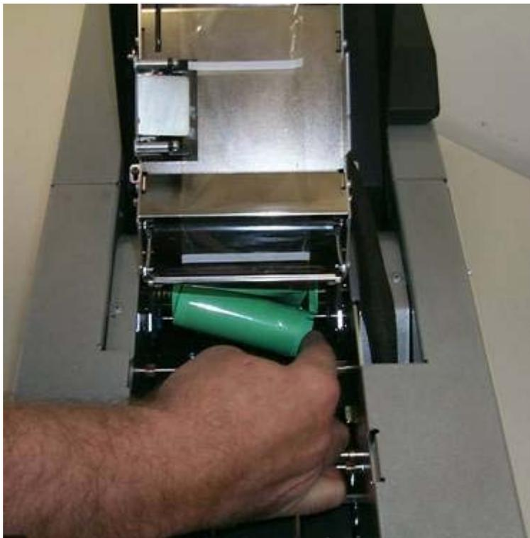
Рисунок С (внизу) – Пленка HDP Film полностью установлена.
